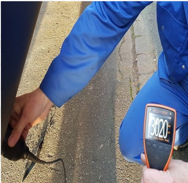
Badanie grubościomierzem ultradźwiękowym
