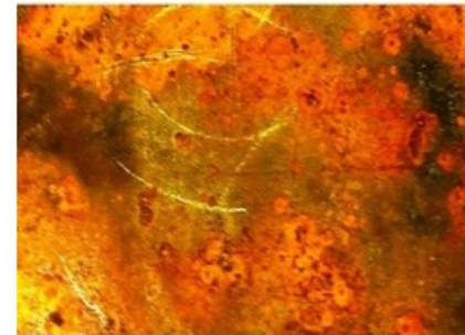
Przykład korozji plamowej
