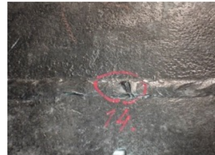
Przykład korozji plamowej
