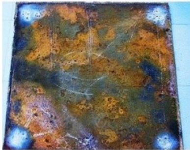
Przykład korozji ogólnej
