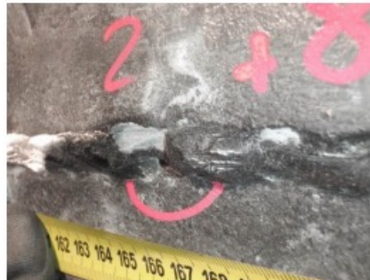
Przykład korozji międzykrystalicznej
