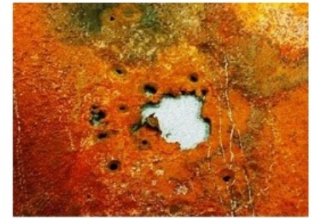
Przykład korozji punktowo-wżerowej
