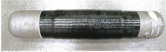
Fot. 3. Próbkę nr 1 – rura z wybraniem materiału z naniesionym systemem naprawczym GC Carbon Wrap. Stan przed badaniem.
