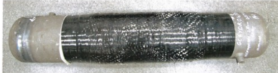
Fot. 2. Próbkę nr 2 – rura z wybraniem materiału z naniesionym systemem naprawczym GC Hydro Wrap. Stan przed badaniem.
