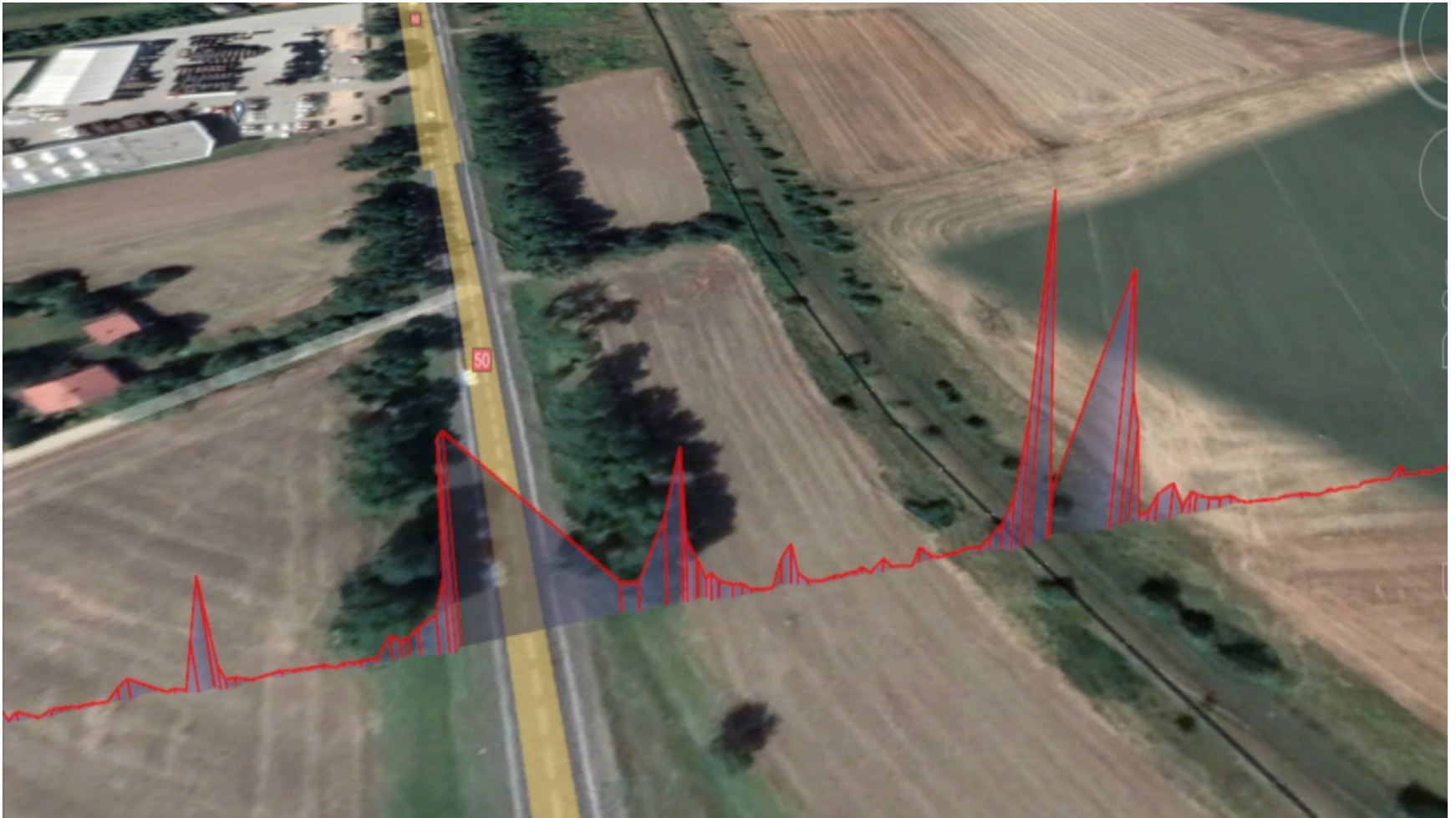
Pomiary gradientu (DCVG), wizualizacja dwóch defektów: jeden przy drodze, drugi przy linii kolejowej
