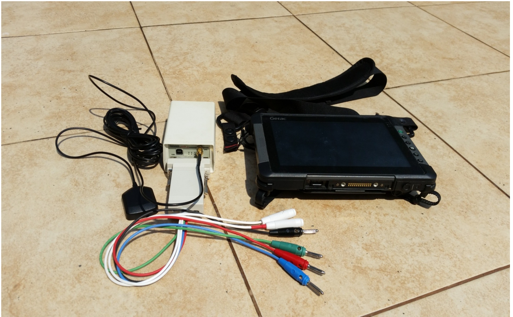
Sprzęt do pomiarów intensywnych – mR4 + wtyczka WDG + antena GPS + tablet
